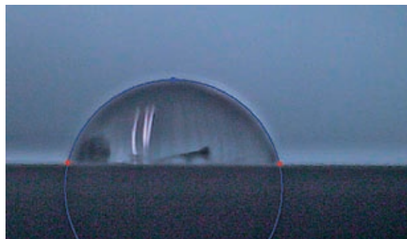
Ryc. 3. Zdjęcie kropli diiodometanu (po lewej) i wody destylowanej naniesionych na powierzchnię polilaktydu
