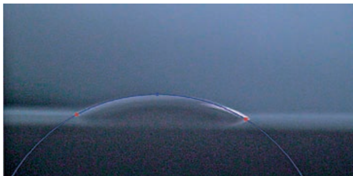
Ryc. 3. Zdjęcie kropli diiodometanu (po lewej) i wody destylowanej naniesionych na powierzchnię polilaktydu
