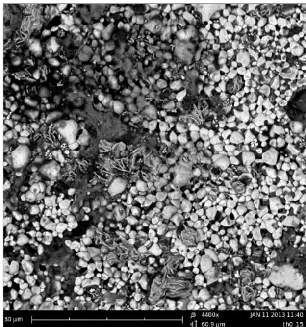
Ryc. 4. Mikrostruktura powierzchni ceramicznych próbek zwartych (TH0) po 3-miesięcznej ekspozycji w organizmie żywym. Na powierzchni widoczne blaszki splotowatej i blaszkowatej tkanki kostnej oraz pojedyncze sferyczne komórki
