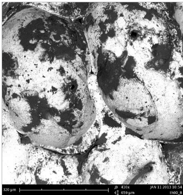
Ryc. 7. Mikrostruktura powierzchni próbek ceramiki porowatej (TH0-90) po 1-miesięcznej ekspozycji w organizmie żywym. Implanty częściowo pokryte komórkami. Widoczne osteoblasty z filopodiami, adherujące do nierównej powierzchni materiału
