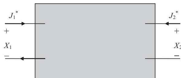
RYC. 1. Ogólna reprezentacja liniowego dwu-portu składającego się z dwóch przepływów ( J_1^* , J_2^* ) i dwóch sił ( X_1 , X_2 ) dla warunków polaryzacji stężeniowej. Dodatni kierunek przepływu jest skierowany do skrzynki. Odpowiednia definicja końcowego portu wymaga, aby przepływ wchodził do dodatniego terminalu (+) i był równy przepływowi wychodzącemu z węzła ujemnego (–) [6]
