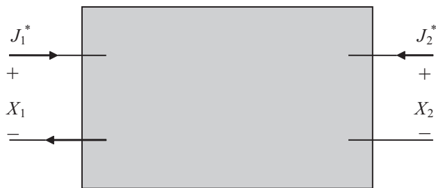
Ryc. 1. Ogólna reprezentacja liniowego dwu-portu, składającego się z dwóch przepływów ( J_1^* , J_2^* ) i dwóch sił ( X_1 , X_2 ) dla warunków polaryzacji stężeniowej. Dodatni kierunek przepływu jest skierowany do skrzynki. Odpowiednia definicja końcowego portu wymaga, aby przepływ wchodził do dodatniego terminalu (+) i był równy przepływowi wychodzącemu z węzła ujemnego (−) [1]
