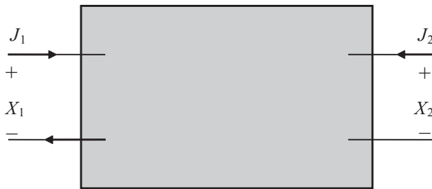
Ryc. Reprezentacja liniowego dwu-portu składającego się z dwóch przepływów i dwóch sił: dodatni kierunek przepływu jest skierowany do skrzynki. Definicja portu końcowego wymaga, aby przepływ wchodził do dodatniego terminalu (+) i był równy przepływowi wychodzącemu z węzła ujemnego (-) [8]
