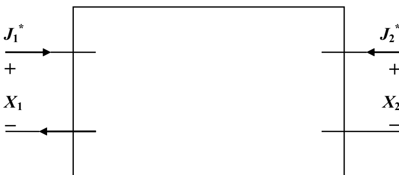
RYC. 1. Ogólna reprezentacja liniowego dwu-portu składającego się z dwóch przepływów ( J_1^* , J_2^* ) i dwóch sił ( X_1 , X_2 ) dla warunków polaryzacji stężeniowej. Dodatni kierunek przepływu jest skierowany do skrzynki. Odpowiednia definicja końcowego portu wymaga, aby przepływ wchodził do dodatniego terminalu (+) i był równy przepływowi wychodzącemu z węzła ujemnego (–) [1]
